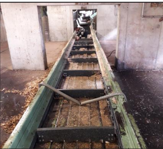
Remise en état de traverses sur chaîne chez
