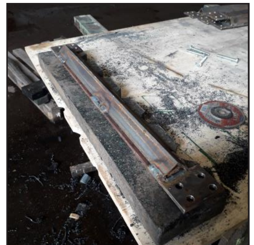
Remise en état de traverses sur chaîne chez
